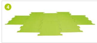
4. Die GREEN LIGNIN Platten werden lose im Verbund mit Versatz um eine halbe Breite auf dem Boden ausgelegt. Falls notwendig fixieren Sie die Platten mit Klebeband.
