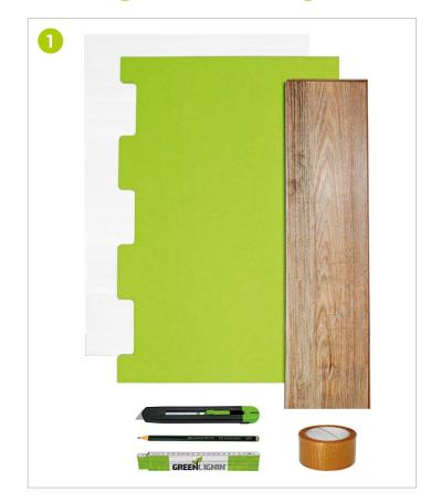
1. Zur Verlegung von GREEN LIGNIN brauchen Sie Cutter, Bleistift, Meterstab und Klebeband. Bereiten Sie vorab den Untergrund vor, prüfen Sie die Restfeuchte und legen Sie ggf. eine Feuchtigkeitsschutzfolie aus.
