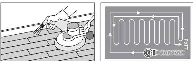
Eine Spritzreinigung kann bei leichten Verschmutzungen und zum Entfernen von Abrieb eingesetzt werden. Bei schwerer Verschmutzung kann zuvor eine Handreinigung mit Mopp / Wischer und Eimer angebracht sein. Korrekt verdünntes neutrales Reinigungs-
