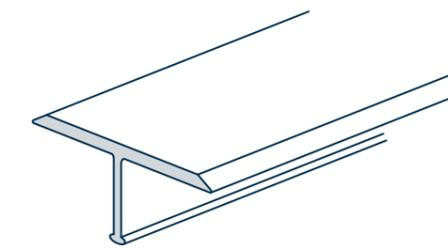
Aluminium-Übergangprofil zur Verwendung in Bereichen mit mittlerer Beanspruchung. Zum Verschrauben.
