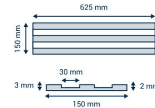
Selbstklebende taktile Polyurethan-Streifen für sehbehinderte Menschen als Orientierungshilfe. Durch die Streifen folgt der weiße Stab dem Leitkanal.
