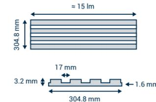
Selbstklebende taktile Führungstreifen aus Polyurethan für sehbehinderte Menschen, um ihnen die Orientierung zu erleichtern.
