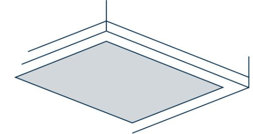
Selbstklebende Deckschicht aus Polyestergewebe zum Schutz des Bodens.
