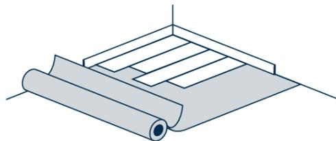
Lose verlegte Unterlage aus silikonierter PET-Trägerfolie mit hochbeständiger Polyurethanschicht und Vliesträger. Speziell entwickelt zur Aufnahme von Geräuschen und für schwimmende Verlegung.
