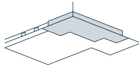
Vorgefertigtes Unterbodenvorbereitungssystem aus MDF in Kombination mit Nadelhölzern für eine einfache und effektive Renovierung auf dem vorhandenen Unterboden.
