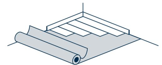
Selbstklebende Unterlage aus mineralischen Füllstoffen und Polyurethan-Bindemitteln zur einfachen Verbesserung der akustischen Leistung unter verklebten und lose verlegten LVT.
