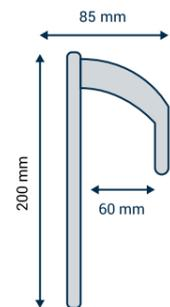
Sockelleistenkappe aus Aluminium, die mit dem Sockelleistenboden zu kombinieren ist, um den Bodenbelag an der Wand als Sockelleiste zu verwenden. Wird geklebt.
