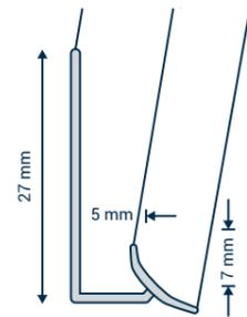
Sockelleistenboden aus Aluminium, der mit der Kappe für Sockelleisten zu kombinieren ist. Wird geklebt.
