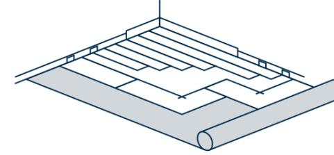
Vorgefertigtes Schnellmontage-Bodenvorbereitungssystem auf MDF, mit Polystyrolschaum, der mit Aluminiumfolie abgedeckt ist.
