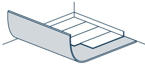
Lose verlegte Unterlage aus viskoelastischem Polymer mit beidseitiger Anti-Rutsch-Textur für verbesserte akustische Eigenschaften.
