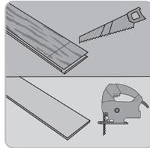
Das Sägeblatt soll immer in die Dekorseite schneiden, also bei Stichsägen von der Rückseite, bei Handsägen von Oben arbeiten. Bei Kreis- oder Kappsägen hängt es von der Höhe des Sägeblattes ab. Verwenden Sie immer ein sauberes und scharfes Sägeblatt.
