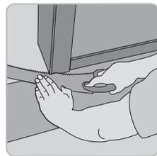
Bei der letzten Reihe platzieren Sie das einzusetzende Paneel exakt auf der zuletzt verlegten Reihe. Verwenden Sie nun ein umgedrehtes Element als Anschlag (+8-10mm) und übertragen Sie so den Wandverlauf. Schneiden Sie entlang der Markierung und setzen den Abschnitt ein.
