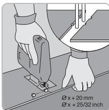
Die genaue Position von Heizungsrohren markieren Sie exakt auf dem Element. Bohren / Schneiden Sie die entsprechenden Aussparungen 20 mm größer, als der Rohrdurchmesser, damit sich der Belag in alle Richtungen bewegen kann.
