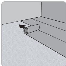
Wir empfehlen die Verlegung auf BerryAlloc Unterlagsmaterial, das am besten zu Ihren Anforderungen passt: Trittschalldämmung, Fußbodenheizung, Dampfbremse,....
