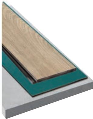
Eine schwimmende Verlegung macht Kleber überflüssig. Sie können die Dielen oder Fliesen einfach zusammenklicken. Mit der Xtrafloor®-Unterlage genießen Sie zusätzlichen Komfort. Damit können kleine Unregelmäßigkeiten ausgeglichen und Umgebungsgeräusche um bis zu 21 dB reduziert werden.
