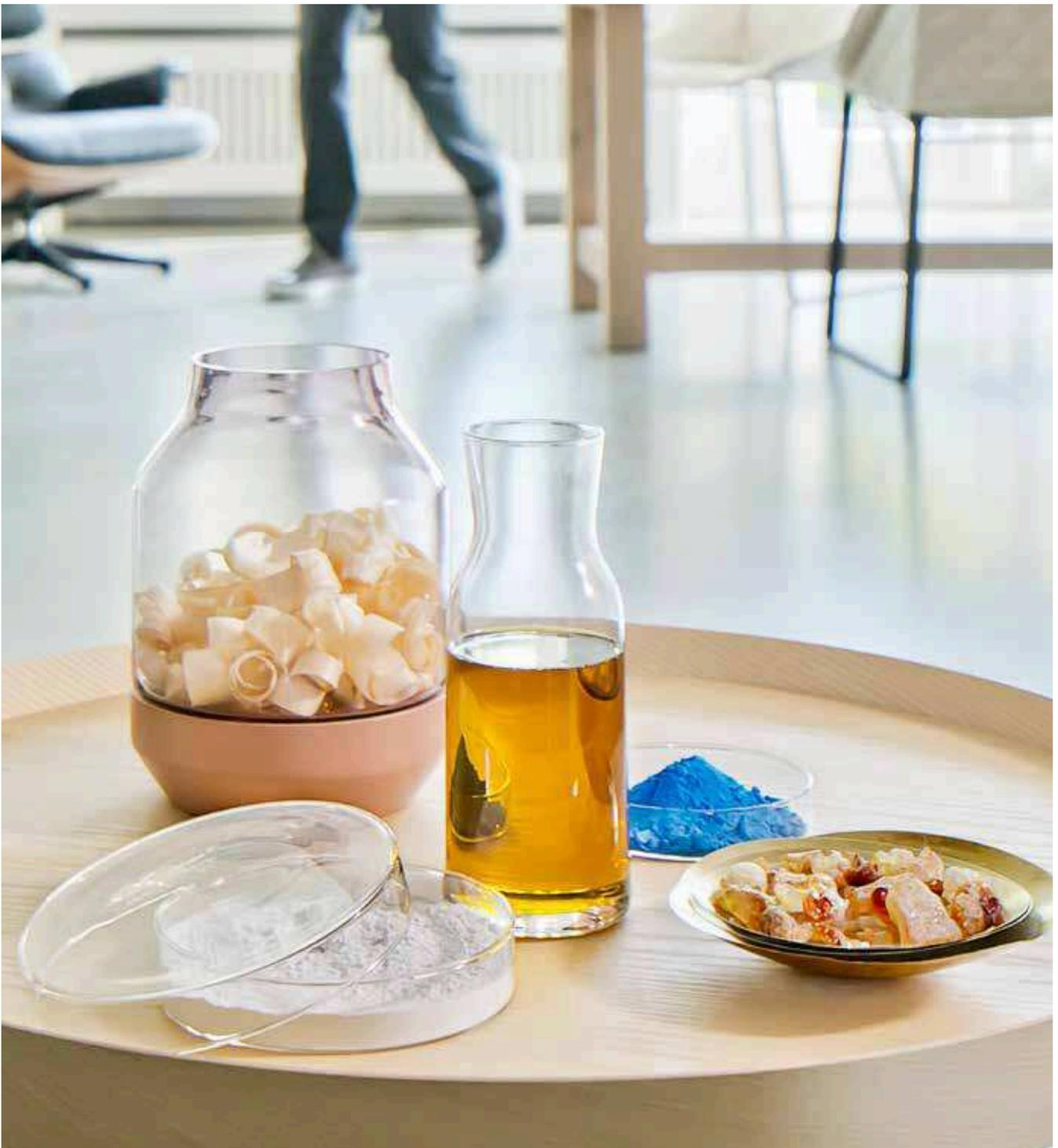
Marmoleum Modular wird aus den nachwachsenden Rohstoffen Leinöl, Naturharz, Holz- und Kalksteinmehl sowie Farbpigmenten gefertigt.
