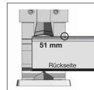
Dann das Profil mit der Markierung deckungsgleich an die Kante der Anschlagfläche anlegen. Die Spannvorrichtung betätigen und Außenecke stanzen.
