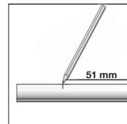
Am Ende das Profil 11 mm überstehen lassen. Vom Ende 51 mm zurückmessen und eine Markierung auf dem Profil anbringen.
