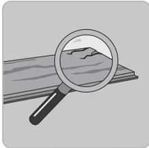
Prüfen Sie jedes Element vor der Verarbeitung auf Beschädigungen, verwenden Sie dabei unbedingt ausreichend geeignete Lichtverhältnisse. Arbeiten Sie idealerweise bei Tageslicht, Baulampen oder Strahler auf dem Boden können das optische Ergebnis verfälschen! Beschädigte oder beeinträchtigte Paneele dürfen nicht verarbeitet werden.
