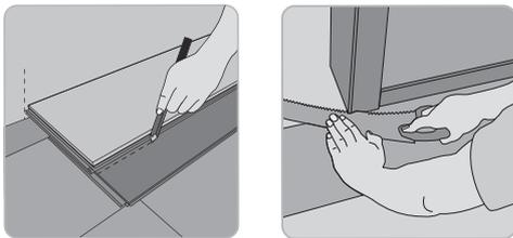
Bei der letzten Reihe platzieren Sie das einzusetzende Paneel exakt auf der zuletzt verlegten Reihe. Verwenden Sie nun ein umgedrehtes Element als Anschlag (+8-10mm) und übertragen Sie so den Wandverlauf. Schneiden Sie entlang der Markierung und setzen den Abschnitt ein.
