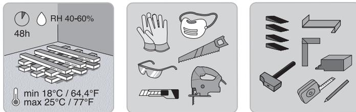
Wichtig! Bewahren Sie die Dielen mindestens 48 Stunden in der ungeöffneten Verpackung bei Raumtemperatur auf, bevor Sie mit der Installation beginnen. Die Raumtemperatur muss vor und bei der Installation mindestens 18-25 °C betragen, die Luftfeuchte zwischen 40-60%.
