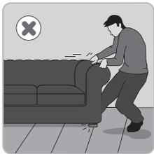
Schützen Sie den Belag durch ausreichend dimensionierte, funktionsfähige und fortlaufend gereinigte Sauberlaufzonen. Im gewerblichen Bereich ist eine dreistufige Abstreifzone mit mindestens je 3 Schrittlängen zwingend erforderlich! Unter allen beweglichen Aufstandsflächen müssen Filz- oder Sondergleiter angebracht sein. Alle Rollen müssen der Ausführung „W“ der DIN EN ISO 12529 entsprechen. Unter Drehstuhlrollen müssen funktionsfähige Schutzmatte eingesetzt werden.
