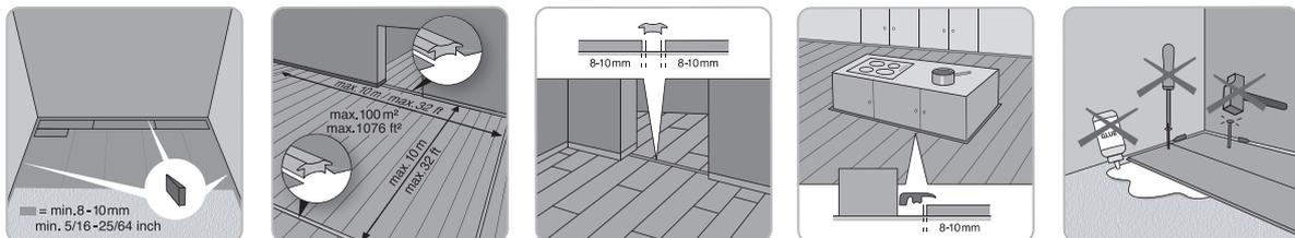
Objekt Laminat AC4 muß immer schwimmend/frei beweglich verlegt werden und darf an keiner Stelle fixiert sein:
