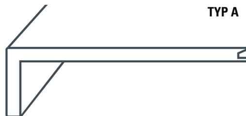
Die Treppenkante A ist eine einfach gebogene Variante, die am vorderen Abschluss ohne Connect-Verbindung endet und einen geraden Abschluss bildet.
