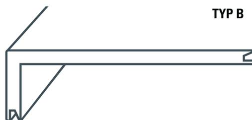
Die Treppenkante B ist eine einfach gebogene Variante, die am vorderen und hinteren Abschluss über eine Connect-Verbindung verfügt. So kann durch Weiterverlegung eine Blockstufe erstellt werden.
