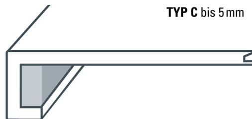
Die Treppenkante C ist eine doppelt gebogene Variante für Bodenbeläge bis 5 mm, die am vorderen Abschluss ohne Connect-Verbindung endet und einen geraden Abschluss bildet.
