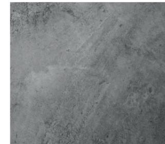
**Neuen Beton zunächst ausreichend trocknen lassen.** Die korrespondierende relative Feuchte in mineralischen Unterböden muss, bei einer Temperatur von mindestens 20 °C, unter 75 % liegen. Feuchtigkeitsgehalt nach CM-Methode max. 2 % CM bei Zementestrich und 0,5 % bei Calciumsulfatestrich (Anhydritestrich).
