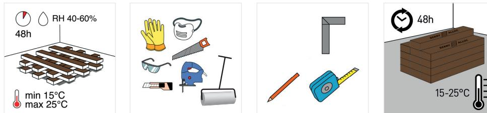
Die Bodenbelagselemente müssen vor dem Verlegen, 48 Stunden lang oder mindestens bis zum Erreichen der Raumtemperatur im geschlossenen Karton und in dem Raum in dem sie verlegt werden sollen, klimatisiert werden. Lassen Sie das Produkt während der Akklimatisierung in den Kartons, die in kleinen Stapeln von höchstens je 5 Kartons abgelegt werden.
