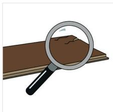
GlueDown-Bodenbeläge sind mittels vollflächiger Verklebung zu verlegen und dürfen nicht auf dem Unterboden verschraubt oder genagelt werden. Zum Schutz der Hände wird das Tragen von Handschuhen empfohlen. Alle Dielen sind vor und während der Verlegung bei optimalen Lichtverhältnissen auf sichtbare Mängel zu prüfen. Fehlerhafte und/oder beschädigte Dielen/Fliesen dürfen nicht verlegt werden.
