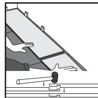
Die zweite Fliese sollte oben angelegt und mit einem Gummihammer leicht festgeklopft werden. Achten Sie darauf, dass die Fliesen exakt ausgerichtet sind und dass Abstandhalter verwendet werden, um die Dehnfuge einzubauen.
