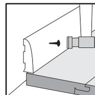
Fußboden-/Sockelleisten können angebracht werden, um die Dehnungsfuge abzudecken, und die Fliesen an den Türrahmen können vor der Verlegung für einen sauberen Abschluss auf die korrekte Form geschnitten werden.
