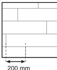
Holzeffekt: Die Fliesen sollten mit zufällig verteilten Verbindungen mit mindestens 200 mm zwischen den kurzen Seiten verteilt werden.
