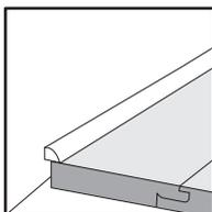
Eine Zierleiste kann angebracht werden, um die Dehnungsfuge abzudecken.
