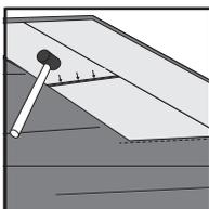
Die nächste Fliese sollte schräg und eng an die vorherige Fliese der Reihe angelegt und dann eingesetzt werden. Die Endverbindung leicht mit dem Gummihammer festklopfen.
