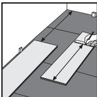
Führen Sie diese Reihe fort, die letzte Fliese schneiden Sie so, dass die Dehnungsfuge eingeplant bleibt.
