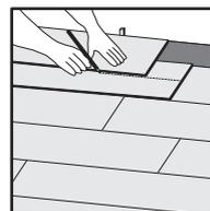
Ergänzen Sie auf diese Weise die Reihen, achten Sie darauf, dass die Verbindungen korrekt anliegen und dass die Fliesen gut miteinander verbunden sind. Die letzte Fliesenreihe wird unter Berücksichtigung der Dehnungsfuge auf die richtige Größe zugeschnitten.
