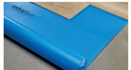
Wie oben empfohlen können Xtrafloor™ Base und Xtrafloor™ Flex Pro kleine Unebenheiten bis **höchstens 5 mm Breite und 2 mm Tiefe** ausgleichen. Dadurch wird ein Verlegen auf bestehenden Bodenbelägen möglich, z. B. Keramikfliesen, Linoleum, Kompakt-PVC-Böden und Bodendielen aus Holz.
